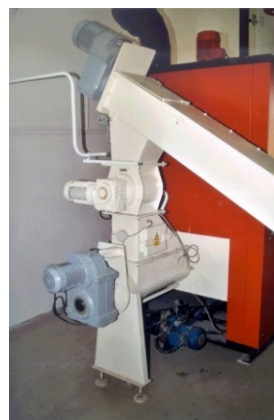
Рис. 19. Шнекова подача соломи від різки соломи до котельної установки
