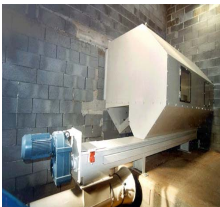
Рис. 19. Шнекова подача соломи від різки соломи до котельної установки
