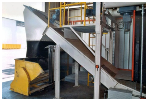
Рис. 21. Видалення золи за допомогою транспортера (вологе)
