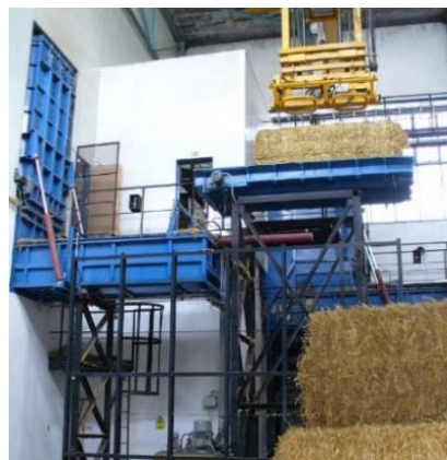
Рис. 66. Мостовий кран та лінія подачі тюкованої соломи
