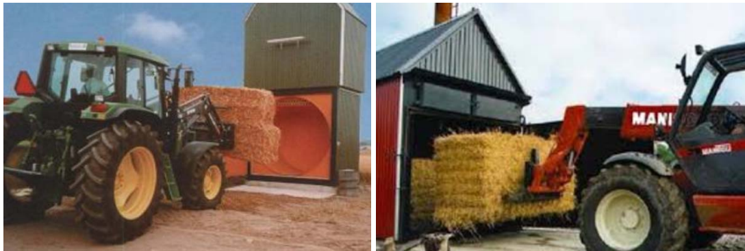
Рис. 17. Завантаження твердого біопалива в біокотел з допомогою фронтального навантажувача.
