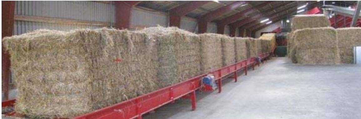
Рис. 41. Конвеєрна лінія для подачі тюкованої соломи
