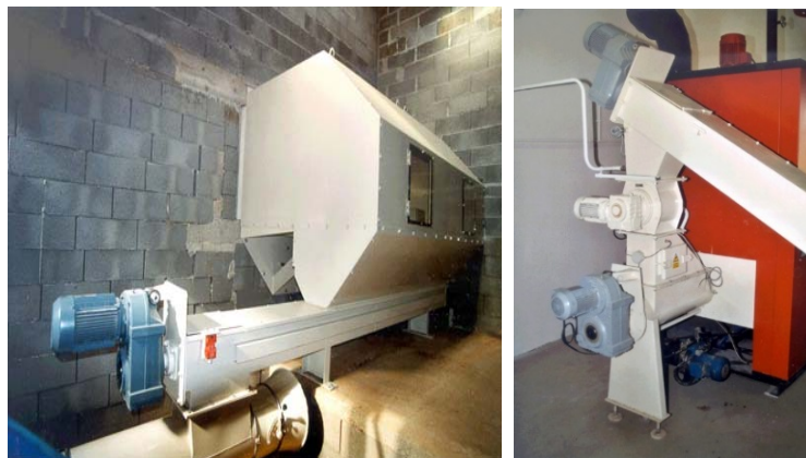
Рис. 50. Шнекова подача соломи від різки соломи до котельної установки
