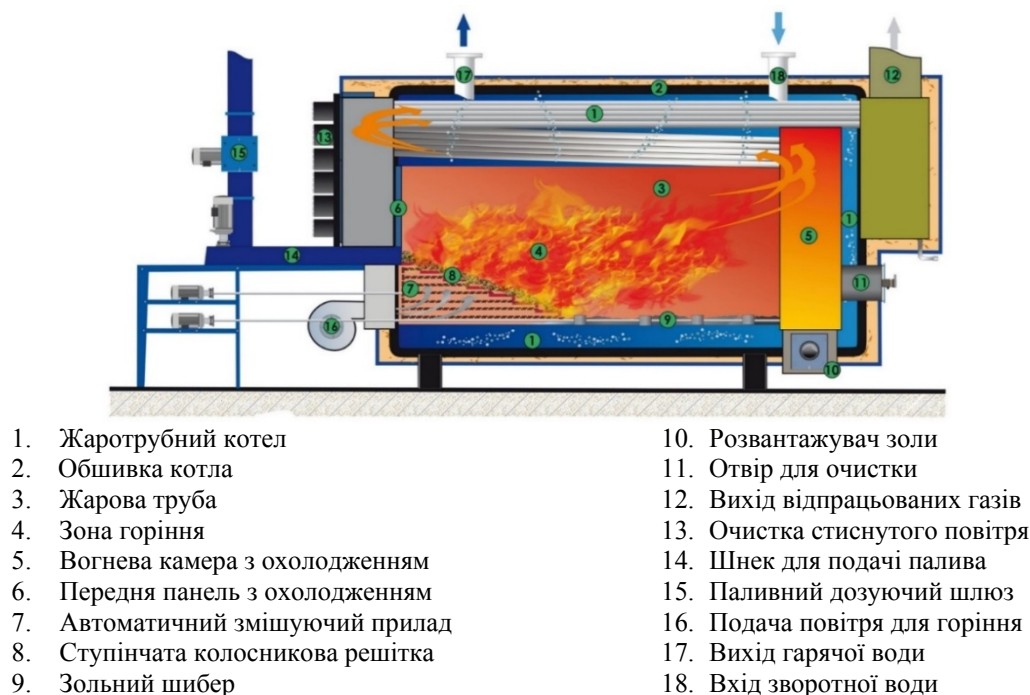
Рис. 44. Схема котла LIN-KA
