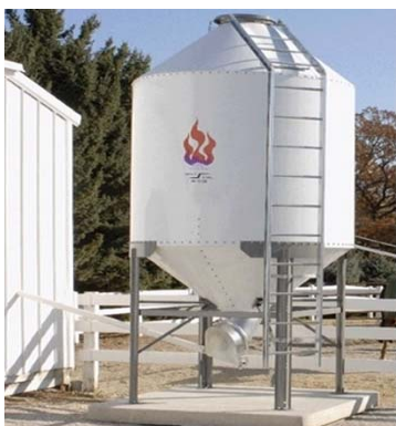
Рис. 6. Вертикальний бункер-накопичувач (силос)
