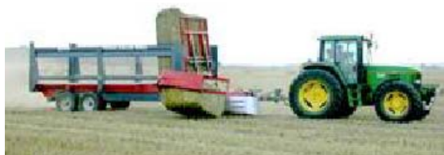
Рис. 38. Самонавантажувач і розвантажувач тюків у скирту модель 900
