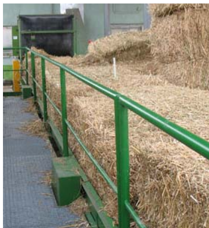
Рис. 55. Конвеєрна лінія для подачі тюкованої соломи
