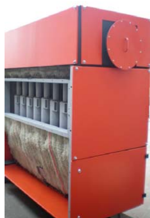
Рис. 64. Мультициклонний фільтр для очистки димових газів
