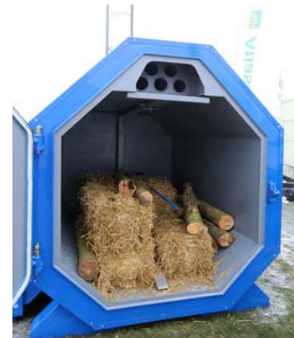
Рис. 16. Твердопаливний біокотел з можливістю механічного завантаження біопалива
