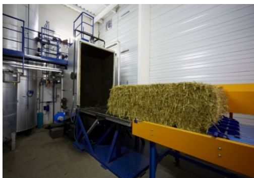
Рис. 67. Завантаження тюка соломи в дозаторний механізм
